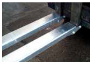
Lever chaque rallonge et la glisser sur la fourche jusqu'à la bloquer derrière le talon.
