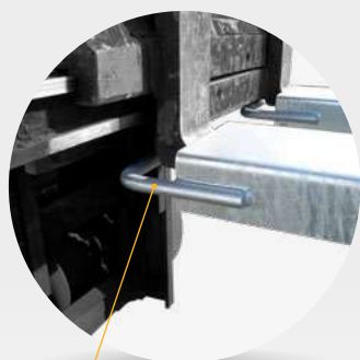
Étriers de retenue sur les 2 fourches
