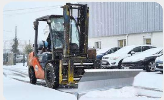
Lame de contact réversible en caoutchouc anti-abrasif, ép. 30x120 mm, haute résistance (60 shores)
