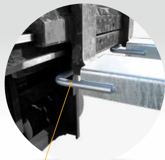
Étriers de retenue sur les 2 fourches
