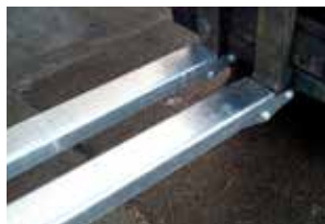
Lever chaque rallonge et la glisser sur la fourche jusqu'à la bloquer derrière le talon.
