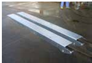
Introduire les fourches dans les rallonges suffisamment pour pouvoir les lever.
