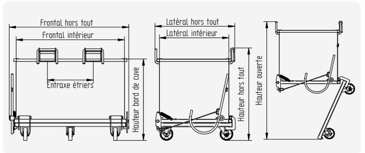
**Vérifier la hauteur de levée du mât de votre chariot : Hauteur ouverte + Hauteur du caisson.**
