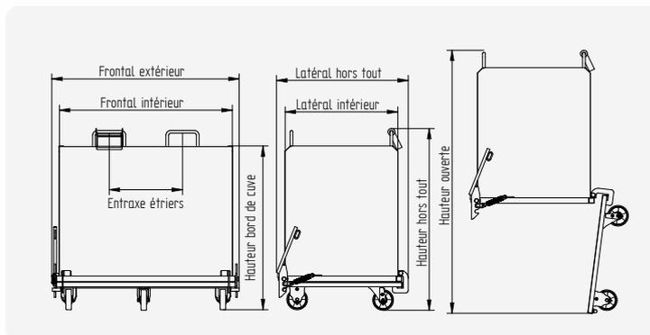
Vérifier la hauteur de levée du mât de votre chariot : Hauteur ouverte + Hauteur du caisson.
