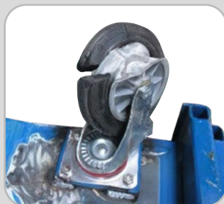
Roue et platine changées par des composants inadaptés
