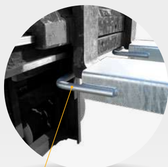
Étriers de retenue sur les 2 fourches
