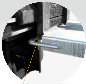
Étriers de retenue sur les 2 fourches
